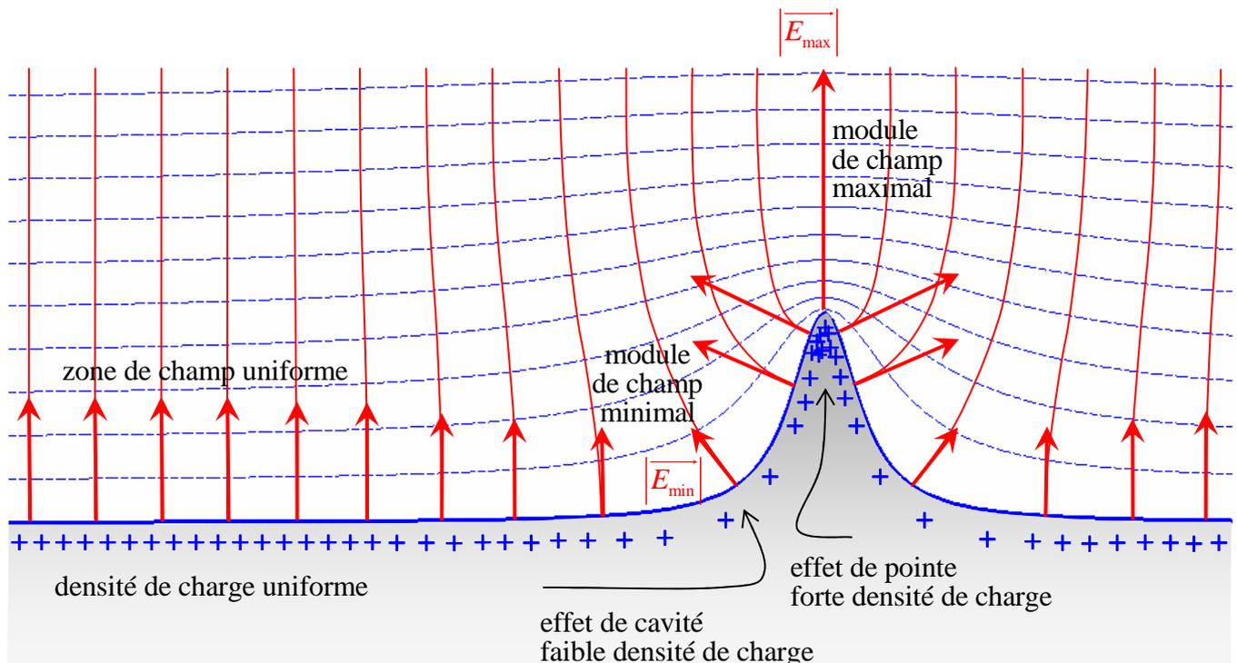
Imaginons la présence d'une pointe métallique orthogonale à cette surface chargée. À grande distance, l'équilibre électrostatique ne sera pas perturbé, mais à courte distance, les surfaces équipotentielles se trouveront resserrées. Cela correspond à un gradient de potentiel particulièrement important dans la direction de la pointe et donc à une composante de champ électrique particulièrement importante dans cette direction : c'est ce phénomène que l'on baptise « *pouvoir des pointes* ».
