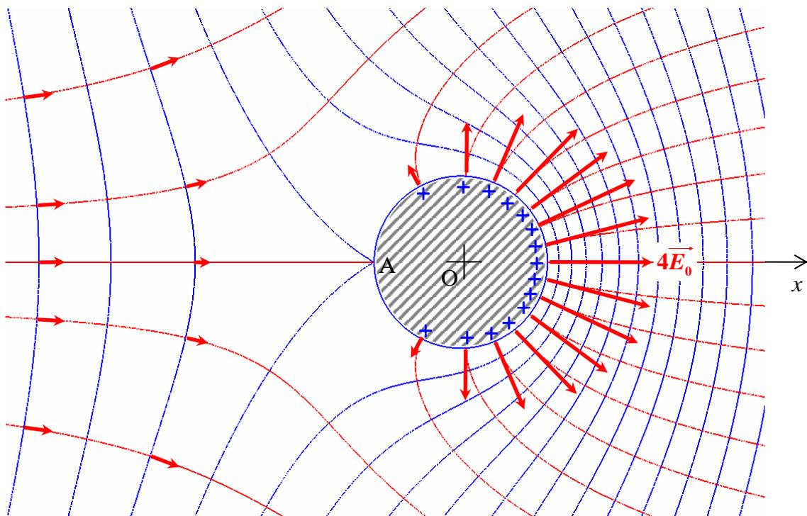
*Remarque* : cette figure est tracée à l'aide d'un logiciel de calcul formel (en l'occurrence, il s'agit de MAPLE). Le tracé de ces courbes à partir des expressions analytiques du champ et du potentiel n'est évidemment pas exigible en temps limité. Par contre, l'interprétation de ce schéma et la reconnaissance sur celui-ci de quelques lois de l'électrostatique est un bon exercice. Par exemple, au vu de la carte des champs et équipotentiels, que vaut le champ électrique au point A ?
